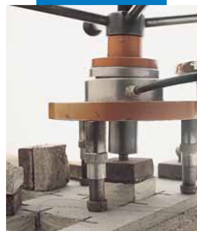
Zkouška tahové přídržnosti k podkladu (SATTEC)
